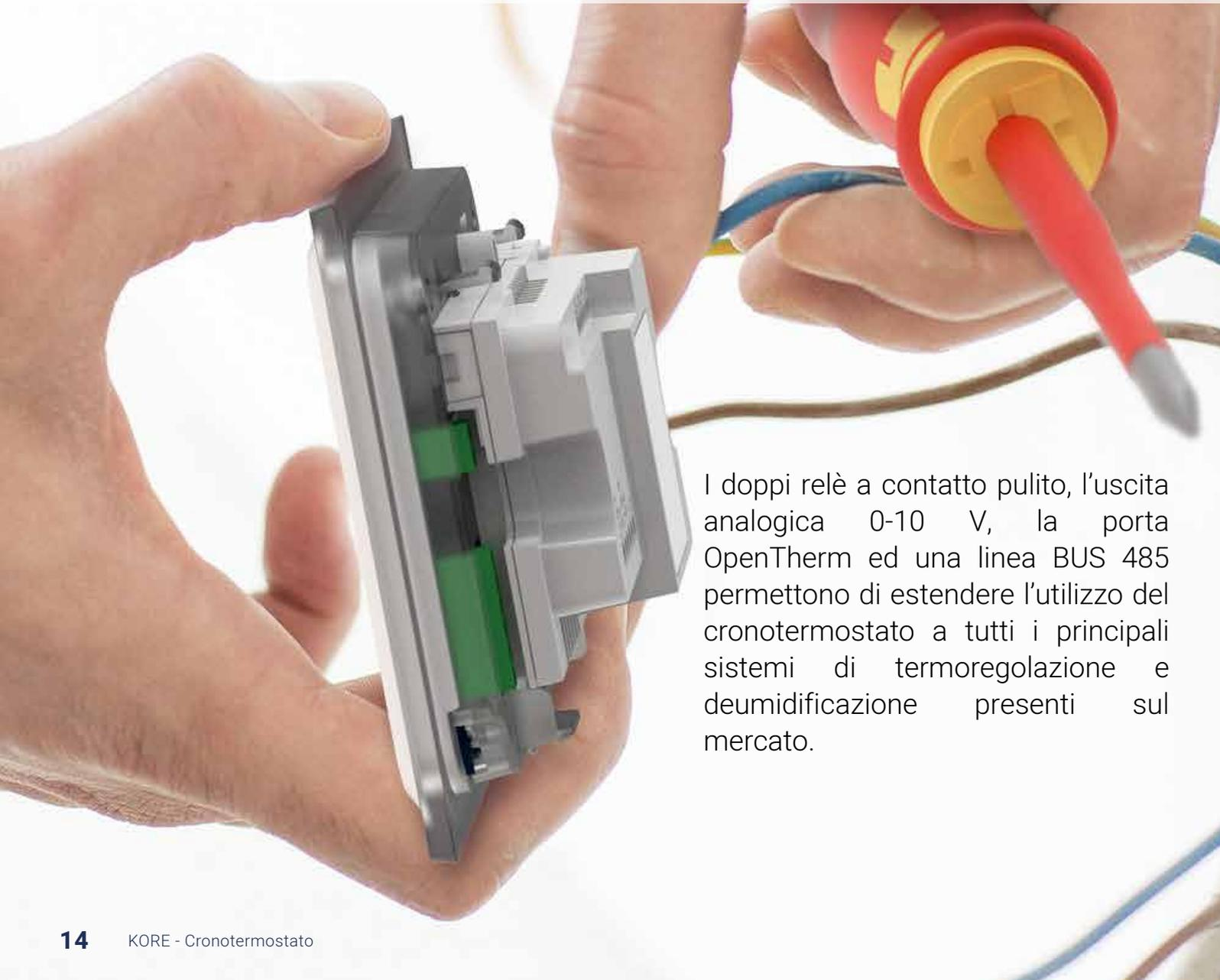
I doppi relè a contatto pulito, l'uscita analogica 0-10 V, la porta OpenTherm ed una linea BUS 485 permettono di estendere l'utilizzo del cronotermostato a tutti i principali sistemi di termoregolazione e deumidificazione presenti sul mercato.
